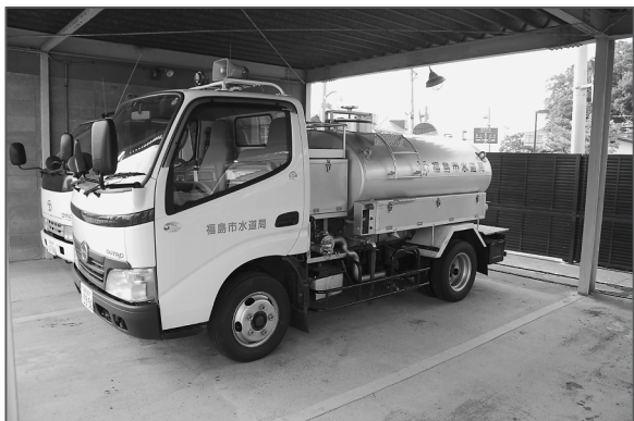
▲局所有2 m 3 圧送式給水タンク車（3台）
